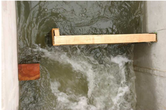
Abb. 3 Schlitzpass von oben gesehen
